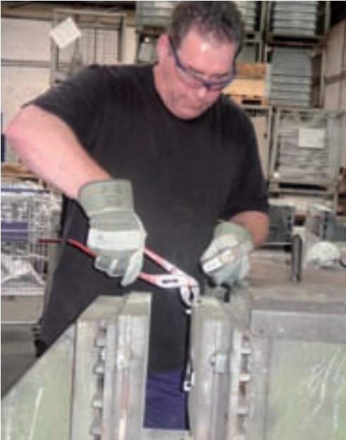
Coquillegieten: vloeibare aluminium wordt handmatig in de vorm gegoten en na stolling verwijderd.
