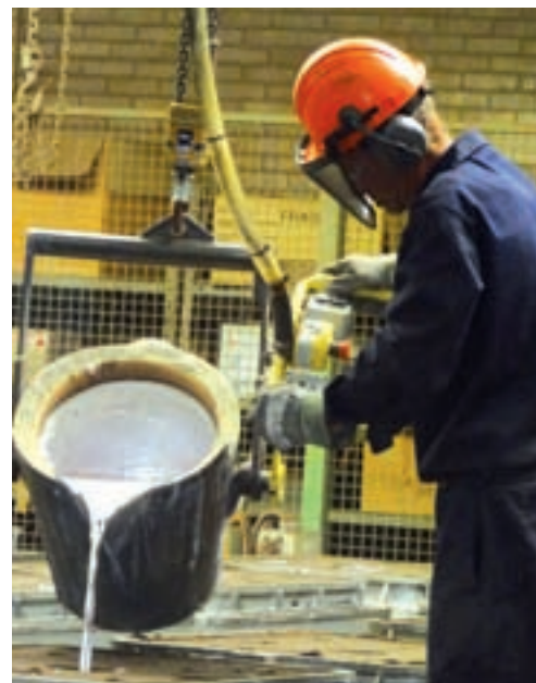
Vloeibaar aluminium wordt in een stalen matrijs gegoten.
