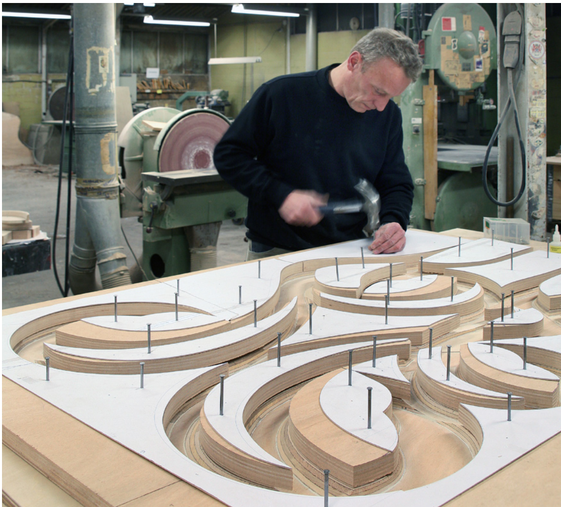
Bij zandgieten worden de afdrucken in het zand gemaakt via mallen van hout of ureol (een polyurethaan kunsthar) en volgegoten met gesmolten gerecyclede metalen.
