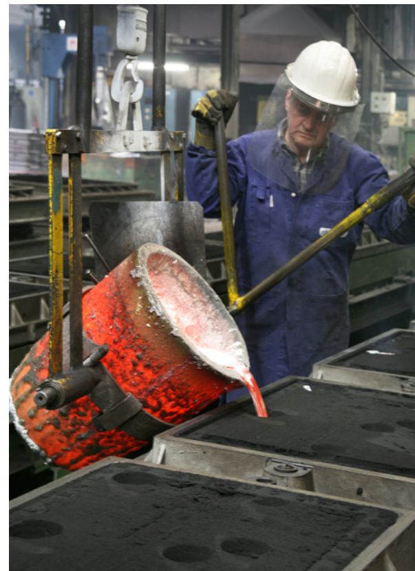
Het zandgietprocédé is bij uitstek geschikt voor enkele stuks tot serie gietwerk.
